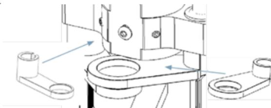
2. Bringen Sie das Glasfaserkabel für die Hintergrundbeleuchtung an; das kurze Ende an das Oberteil des Lampengehäuses, das lange Ende an den Glasfaserkabel-Schwenkarm neben dem Spiegel.
